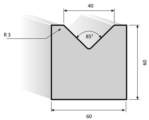
Utensili per presse piegatrici realizzati con standards di qualità superiore, temprati a induzione sulle parti di lavoro e totalmente rettificati. Lunghezza standard: 835 mm; 415 mm; 835 sezionati.
