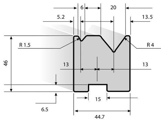
Utensili per presse piegatrici realizzati con standards di qualità superiore, temprati a induzione sulle parti di lavoro e totalmente rettificati. Lunghezza standard: 835 mm; 415 mm; 835 sezionati.
